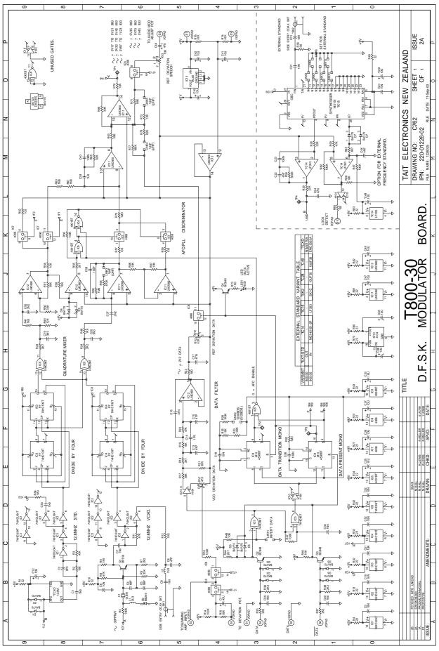
Figure 9 T800-30-0000/0002 Circuit Diagram (IPN 220-01226-02)
