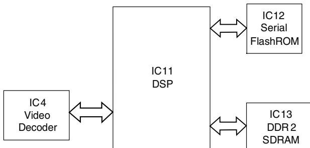
Fig. 1 DSP circuit
