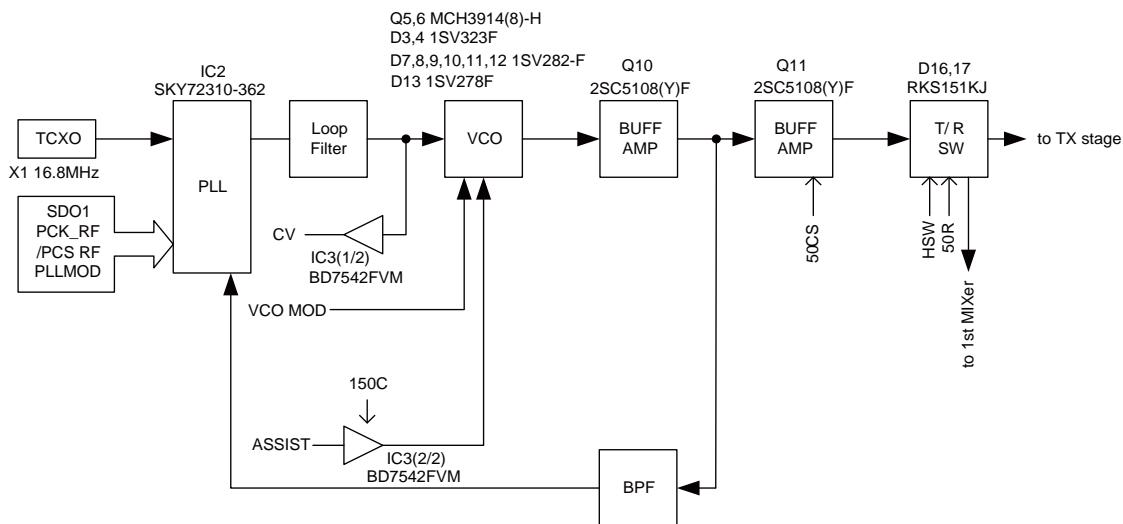
Fig. 6 PLL circuit
