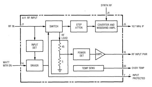
Figure 5-5. Power Meter Block Diagram
