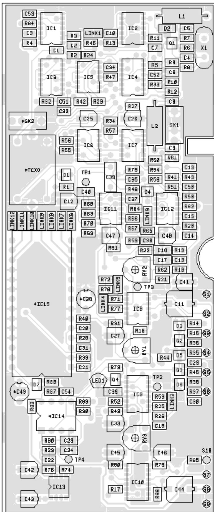
Figure 10 T800-30-0000/0002 PCB Layout - Top Side (IPN 220-01226-02)
