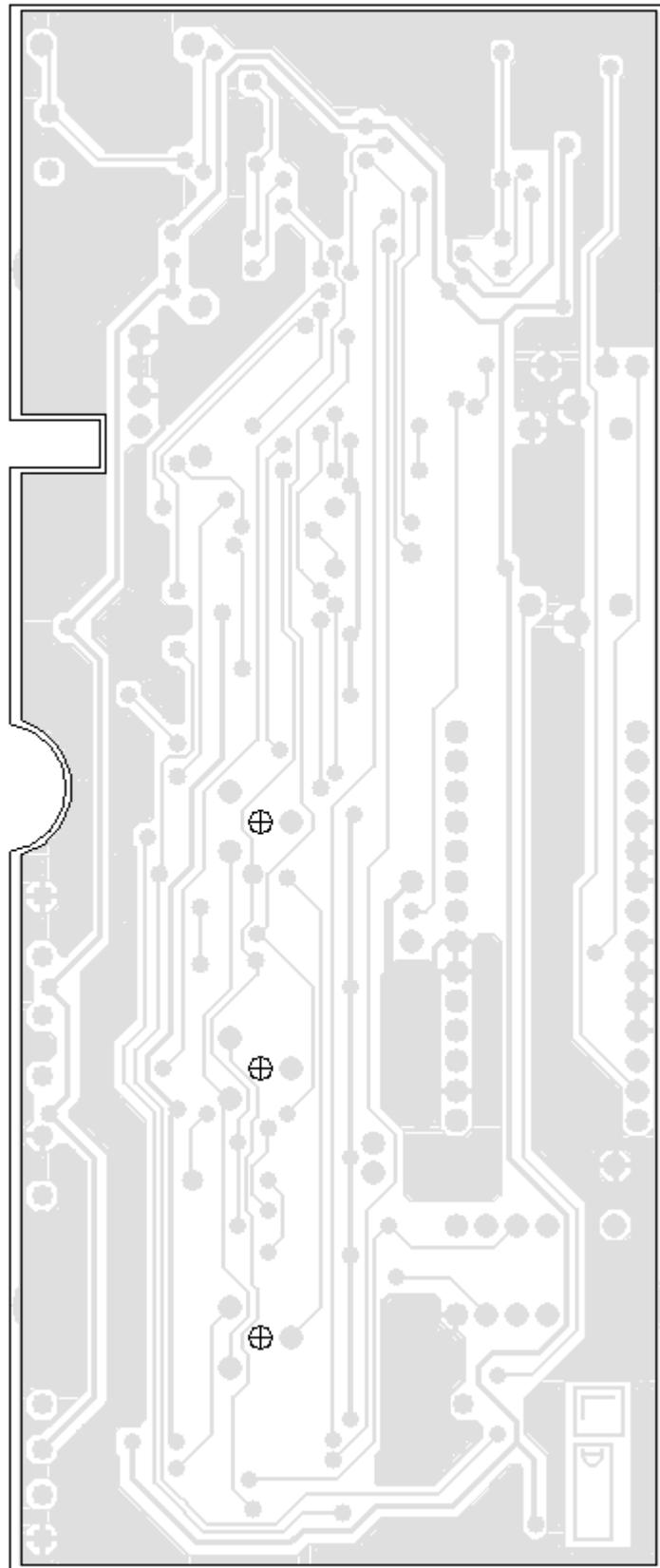
Figure 11 T800-30-0000/0002 PCB Layout - Bottom Side (IPN 220-01226-02)
